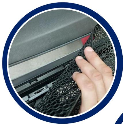
Благодаря своей гибкости и способности адаптироваться к сложной геометрии деталей, полимерная сетка легко принимает форму бампера, обеспечивая плотное и надежное прилегание.
